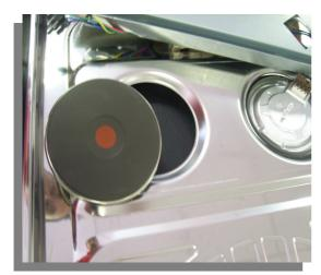
Remplacez alors la plaque défectueuse et remontez le tout en prenant soin de ne pas pincer un câble dans le châssis métallique.
